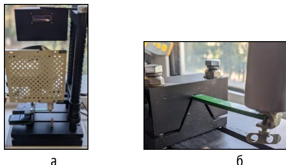
Рисунок 1 – Общий вид прибора «Буслик-1» для усталостных испытаний (а) и узел закрепления образца (б)
